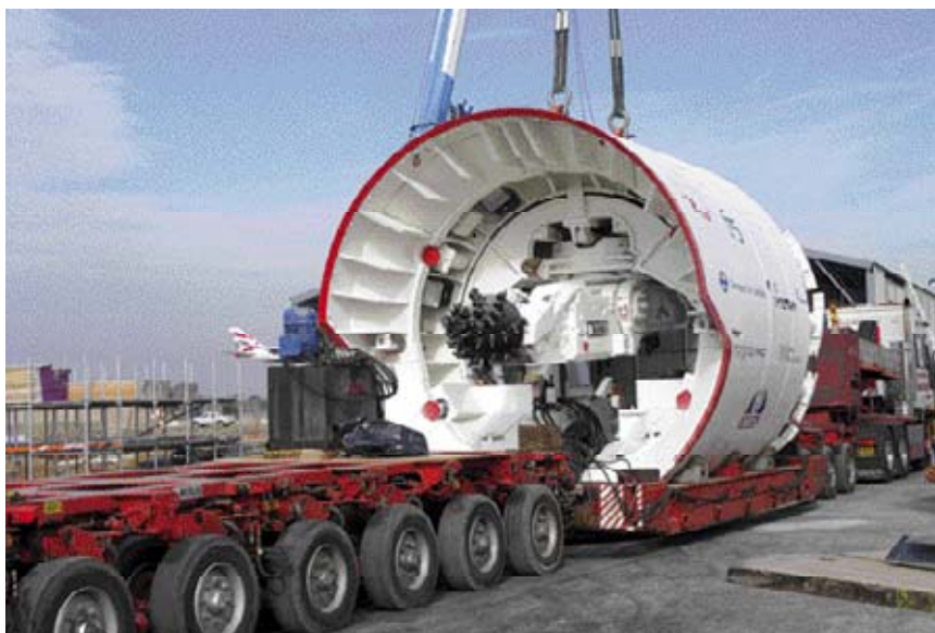
Obr. 3 – Tunelovací štít pro ražbu tunelů PiccEx
