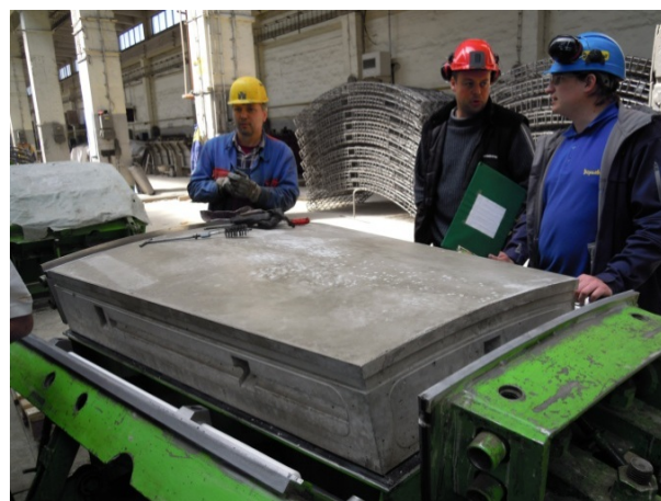
Obrázek 4. Betonáž drátkobetonového klenáku a odbednění klenák
