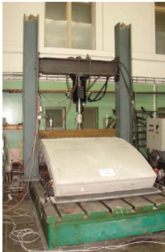
Obrázek 3. Segment zatížený ohybem kolmým na rovinu segmentu
