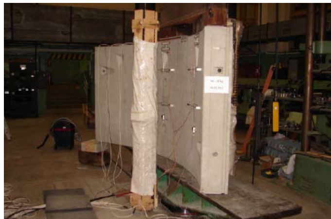
Obrázek 7. Segment zatížený v prostém tlaku dvěma břemeny
