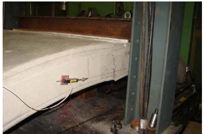
Obrázek 5. Segment zatížený ohybem kolmým na rovinu segmentu po porušení (boční pohled)
