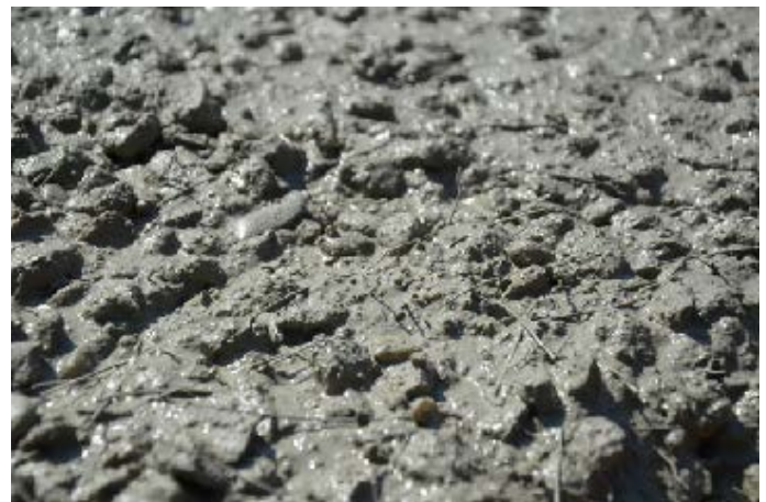
Obrázek 4. Čerstvý drátkobeton (délka drátků je 60 mm)
