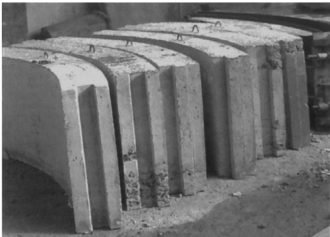
Obrázek 8. Drátkobetonové segmenty vyrobené a zkoušené v Československu v letech 1984 - 1988
