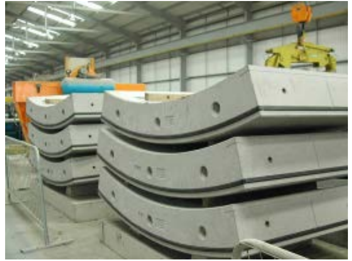
Obrázek 3. Skladování prefabrikovaných železobetonových segmentů
