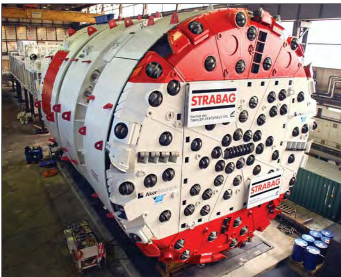
Obr. 4 TBM do skalních hornin s dvojitým štítem od společnosti Aker–Wirth Fig. 4 Double-shielded hard rock TBM manufactured by Aker–Wirth
