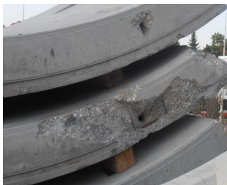
Obr. 3,4.: Porušení krycích vrstev segmentu na styčných spárách
