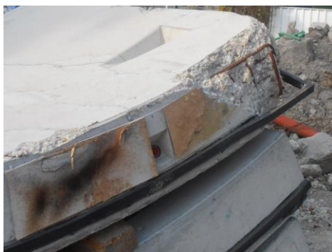
Obr. 3,4.: Porušení krycích vrstev segmentu na styčných spárách
