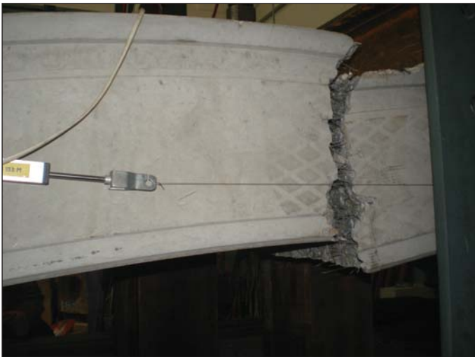
Obr. 5 Segment zatížený ohybem kolmým na rovinu segmentu po porušení (boční pohled)
