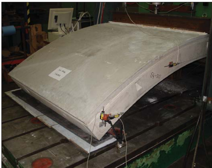
Obr. 3 Segment zatížený ohybem kolmým na rovinu segmentu Fig. 3A segment loaded by bending perpendicular to the segment plane
