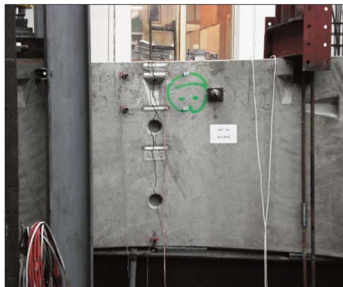
Obr. 15 Porušení železobetonového segmentu zatíženého ohybem v rovině segmentu
