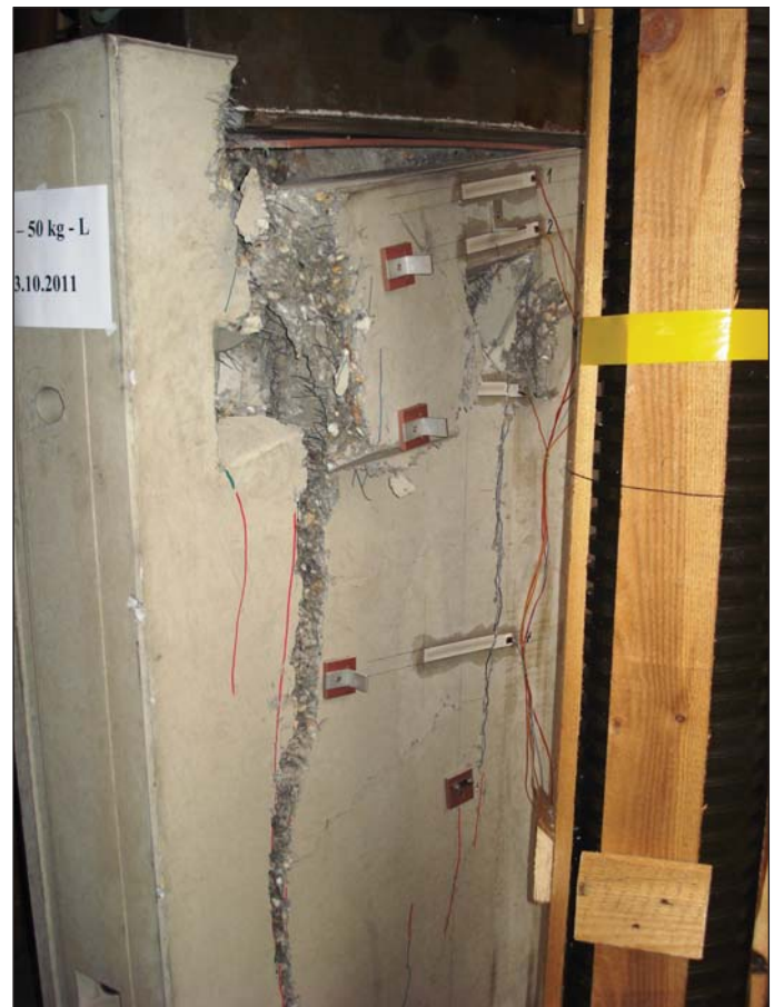
Obr. 6 Rozštípnutí zbytku segmentu příčnými tahy
