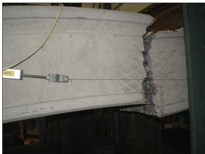
Obr. 5 Vytržení drátků z betonu při úplném porušení Fig. 5 Steel fibres pulled out of concrete at total failure
