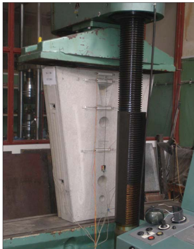
Obr. 8 Zatěžovací zkouška drátkobetonového segmentu prováděná v Kloknerově ústavu
