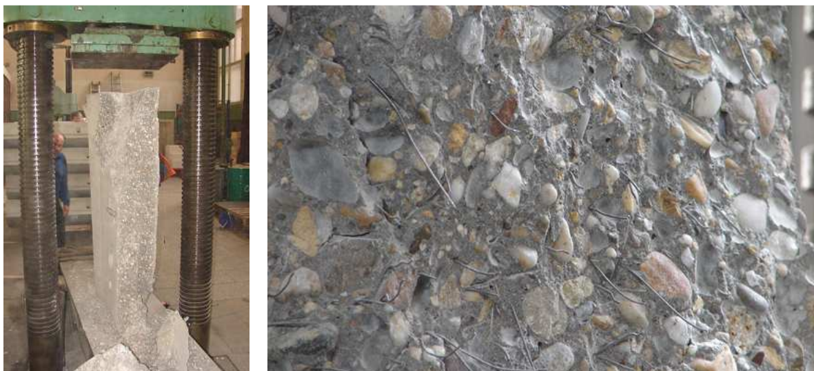
Obr. 7 Drátkobetonový klenák po zkoušce včetně způsobu jeho porušení
