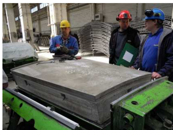
Obr. 4 Betonáž drátkobetonového klenáku; odbedněný klenák, Prefa Senec SK
