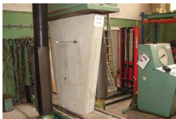
Obr. 5 Uspořádání zkoušky klenáku – KÚ, ČVUT v Praze
