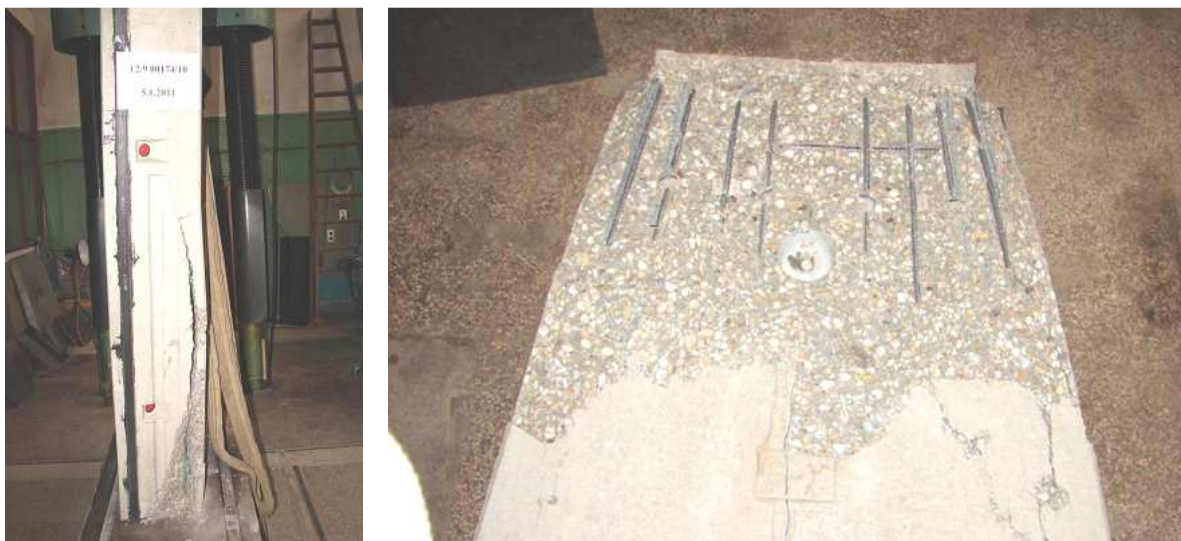
Obr. 6 Železobetonový klenák po zkoušce včetně způsobu jeho porušení
