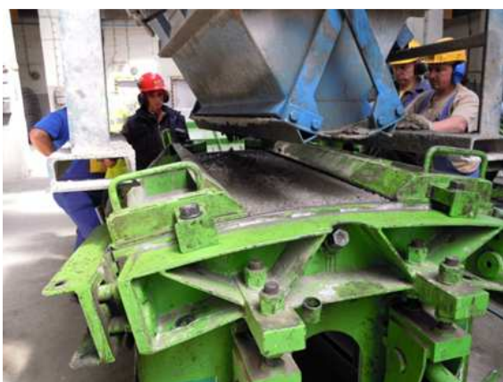
Obr. 4 Betonáž drátkobetonového klenáku; odbedněný klenák, Prefa Senec SK
