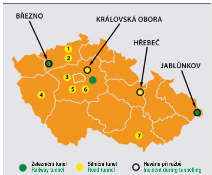
Obr. 1 Orientační poloha silničních a železničních tunelů s průzkumnými štolami realizovaných NRTM v letech 1990–2010 na mapě ČR (1 – Panenská, 2 – Prackovice, 3 – Mrázovka, 4 – Valík, 5 – Slivenec SOKP 514, 6 – Komořany SOKP 513, 7 – Královopolský)
