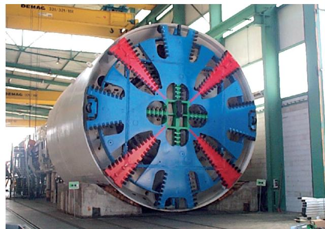
Obr. 4 – TBM použitý pro ražbu
