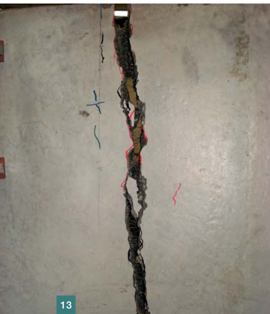
Obr. 11 Porušení drátkobetonového segmentu tlakem ■ Fig. 11 Damage in fibre reinforced concrete segment loaded in copression
